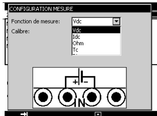
Les branchements en mode mesure se font sur les quatre bornes « IN » situées dans la moitié gauche de l'appareil:
