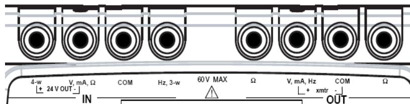
Les 8 bornes du CALYS 50 / 75 / 100 sont « push & lock ». Elles acceptent les fiches bananes 4mm, les fils nus, les cosses à fourche et les connecteurs miniatures pour thermocouples.
