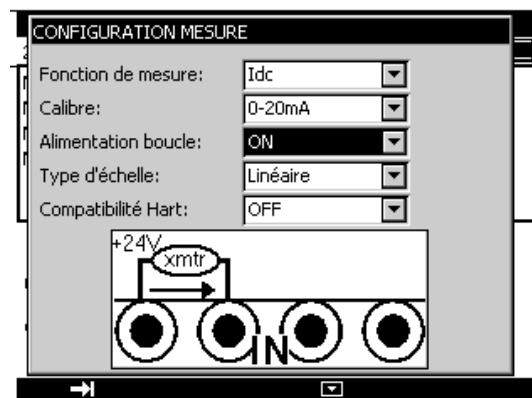
Dans ce cas, le CALYS 50 / 75 / 100 alimente un transmetteur passif en 24V et mesure en même temps le courant établi par le transmetteur.
