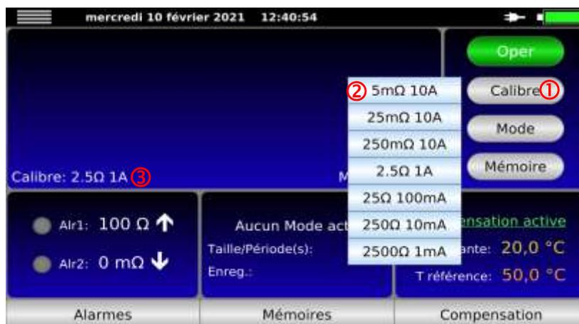
Le calibre et le courant de mesure sélectionnés s'inscrivent sur l'écran ( ③ )
