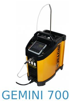
Four d'étalonnage portable grande capacité, 50°C à 700°C
