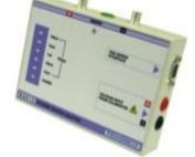
L'adaptateur permet d'étalonner les électromètres sensibles et les ampèremètres pour courant faible avec une grande précision et de manière sécurisée.
