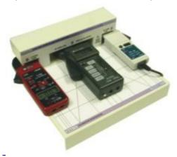
Conçue pour l'étalonnage de pinces ampèremétriques AC/DC, cette option externe dispose de fonctions inédites dans un boitier robuste comprenant une table d'alignement pour un meilleur confort d'utilisation.
