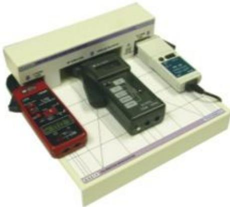
Conçue pour l'étalonnage de pinces ampèremétriques AC/DC, cette option externe dispose de fonctions inédites dans un boîtier robuste comprenant une table d'alignement pour un meilleur confort d'utilisation.
