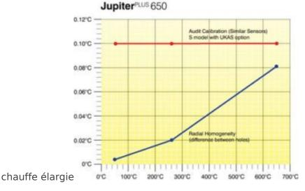
• Gamme de température :Le Jupiter offre une gamme jusqu'à 660°C, cette température correspondant à la valeur maximale des SPRT. Cette particularité permet une grande précision sans risque de dépasser la température limite des sondes résistives
