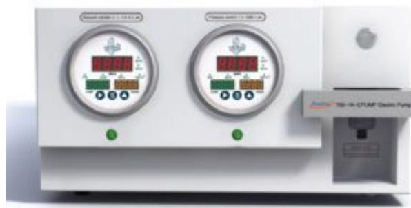
Génère du vide à 70 bars Filtre intégré et piège à liquide Gamme de pression -0.95 à 75 bar Masse 31.6 kg Dimensions 440 X 235X 550 mm Alimentation 100 à 250V Media Air Port de connexion pression G1/8F Température de stockage -20°C à 70°C Environnement de travail 0-95% HR sans condensation Montage Table - option Kit de montage rack Contrôle 2 LEDS avec réglage des limites de pression Temps de montée à la pression max Environ 2 minutes avec le contrôleur ADT 780
