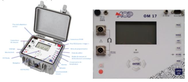
L'utilisation principale du microhmmètre est sur le terrain. En effet, avec son boîtier (IP53 ouvert/IP64 fermé), et ses bornes de mesure métalliques à verrouillage, il propose des performances dignes d'un appareil de laboratoire.
