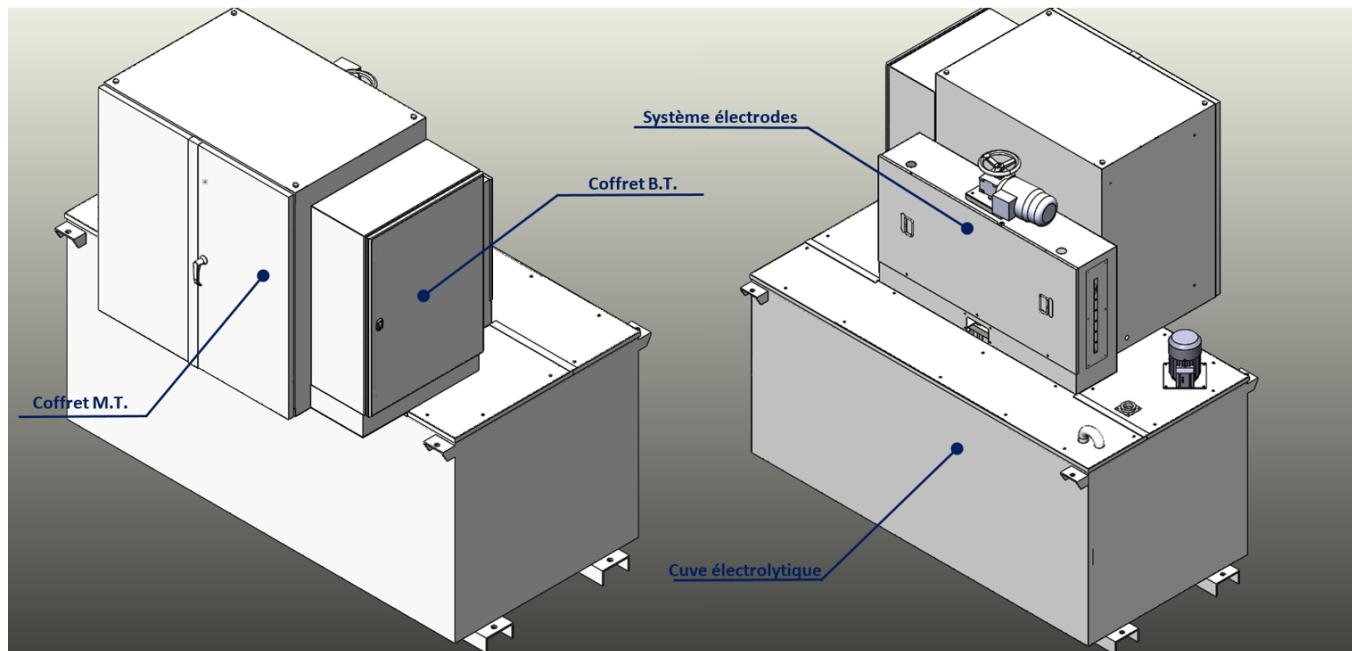
Chaque démarreur est proposé avec un système agitateur (hélice ou pompe) pour assurer l'homogénéité thermique et chimique de l'électrolyte. Des thermostats et un détecteur de niveau sont installés pour assurer la sécurité du démarreur.
