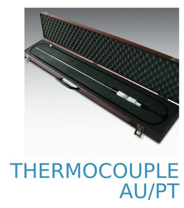
Thermocouple Au/Pt, 0 à 1000°C
