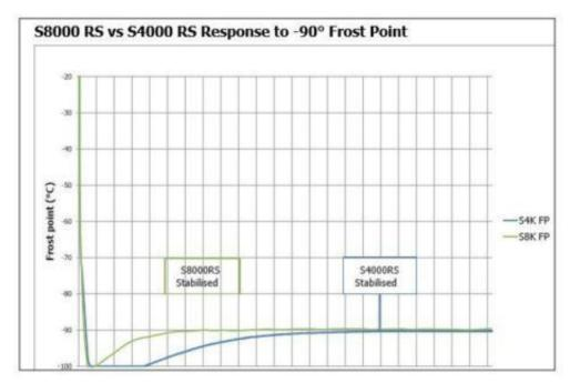
Le graphique ci-contre compare la vitesse de réponse du S8000 RS avec celle de son prédécesseur, le S4000 RS, sur un échantillon dont le point de gel est -90 °C. On remarque que la stabilisation avec le S8000 RS s'effectue trois fois plus vite qu'avec le S4000 RS.
