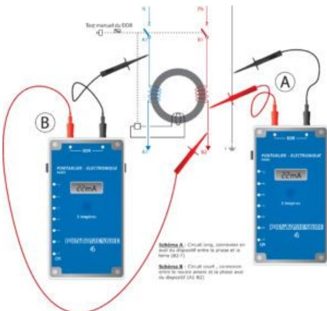
Ses gammes de mesures sont automatiques et la plage de mesure permet de contrôler les seuils entre 15 mA et 3 A (seuils de déclenchements industriels) sous des tensions jusqu'à 400V.
