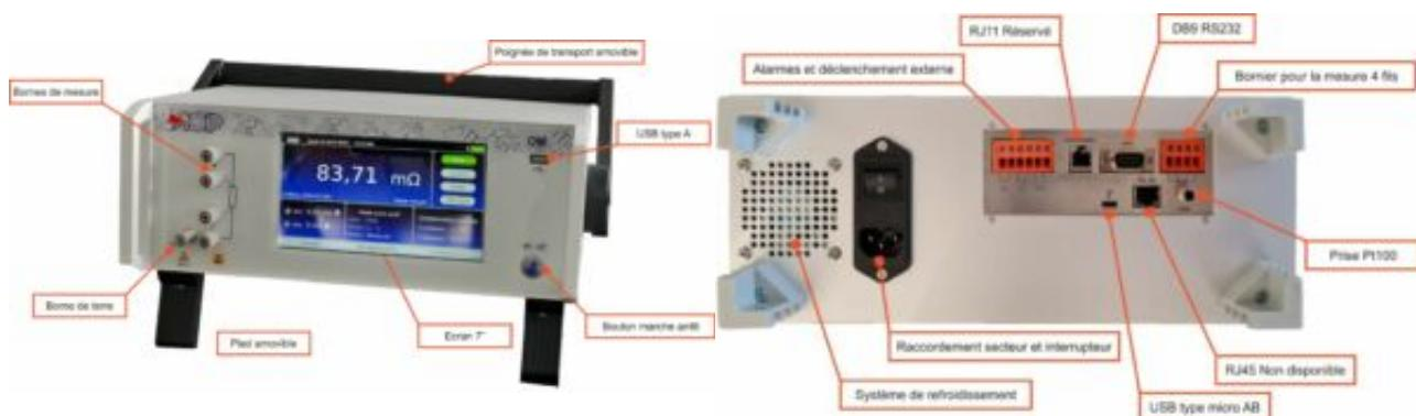
L'OM27 inaugure notre nouvelle interface tactile 7" en couleur, qui permet d'améliorer l'expérience de l'utilisateur en simplifiant l'utilisation et le réglage de l'appareil. La mesure se déclenche automatiquement lorsque la continuité est établie, les mesures sont donc faisable par un seul opérateur.
