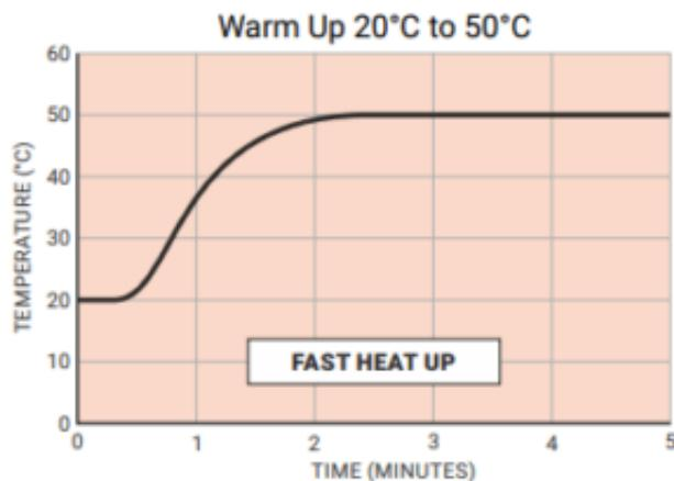
cette vitesse permet d'effectuer des étalonnages rapidement en plusieurs points de vos thermomètres sans contact
