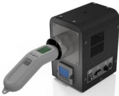
De plus pour les applications où la source est utilisée à une température fixe unique, par exemple 38 ° C, la température réglée sur le contrôleur peut être verrouillée pour éviter toute modification accidentelle ou toute altération.
