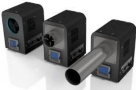
Pour réduire la sensibilité aux courants d'air et aux effets de la température ambiante, un tube en acier inoxydable peut être installé devant la plaque.
