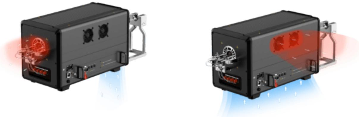
tandis qu'un second flux circule du côté vers le dessous , permettant ainsi de refroidir plus rapidement le four, augmentant la productivité lors des étalonnages
