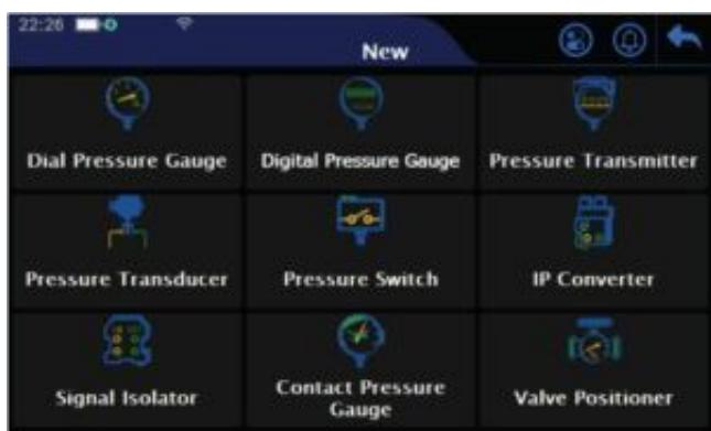
La puissante application de tâche d'étalonnage documentée permet aux utilisateurs de créer et d'exécuter rapidement des tâches sans avoir besoin d'un PC ou d'une tablette. L'ADT762W analyse automatiquement les erreurs, génère des rapports de test, tout en stockant les résultats localement. L'Additel 762W peut prendre en charge jusqu'à 1000 tâches documentées qui peuvent être stockées et rappelées à tout moment pour vous faire gagner du temps et de l'argent.
