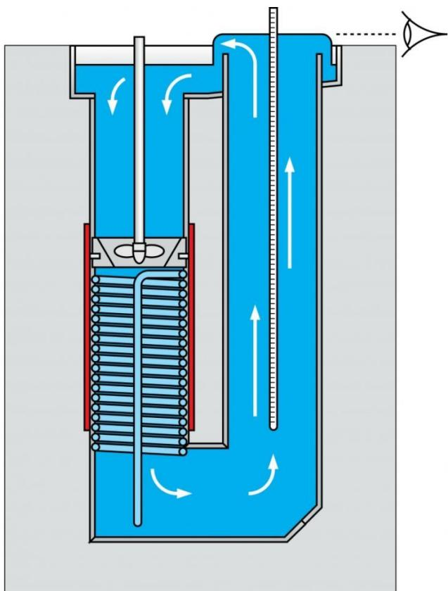
1. Le liquide descend dans la chambre de mélange à travers une plaque avec un orifice d'écoulement. Le flux peut être ajusté depuis le panneau de contrôle.
