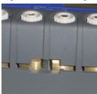
Ce système unique de connexion s'utilise en pressant sur le dessus de la borne et en insérant les fils (jusqu'à 3 mm ou 10 AWG de diamètre) et fiches thermocouples compensées miniatures puis en relâchant la pression. Les fils sont maintenus entre deux plaques de laiton qui assurent un excellent gradient thermique, ce qui procure une très bonne compensation de soudure froide lors de l'utilisation de thermocouples. Il permet également de
