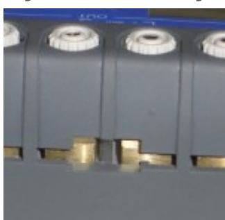
Ce système unique de connexion s'utilise en pressant sur le dessus de la borne et en insérant les fils (jusqu'à 3 mm ou 10 AWG de diamètre) et fiches thermocouples compensées miniatures puis en relâchant la pression. Les fils sont maintenus entre deux plaques de laiton qui assurent un excellent gradient thermique, ce qui procure une très bonne compensation de soudure froide lors de l'utilisation de thermocouples. Il permet également de
