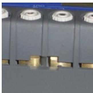
Ce système unique de connexion s'utilise en pressant sur le dessus de la borne et en insérant les fils (jusqu'à 3 mm ou 10 AWG de diamètre) et fiches thermocouples compensées miniatures puis en relâchant la pression.
