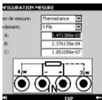
Grâce au calibre 50 KOhm et à l'équation de Steinhart – Hart, des thermistances peuvent être implémentées dans le CALYS 150. L'équation Steinhart-hart est :
