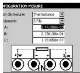
Grâce au calibre 50 KOhm et à l'équation de Steinhart – Hart, des thermistances peuvent être implémentées dans le CALYS 150. L'équation Steinhart-hart est :  $\underline{1} = A + B (ln(R)) + C(ln(R))3 T Où A$ , B et C sont calculés à partir des temperatures à 0°C, 25°C et 70°C.
